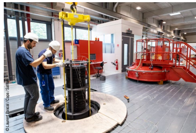
Chargement d'un four de CVI.
