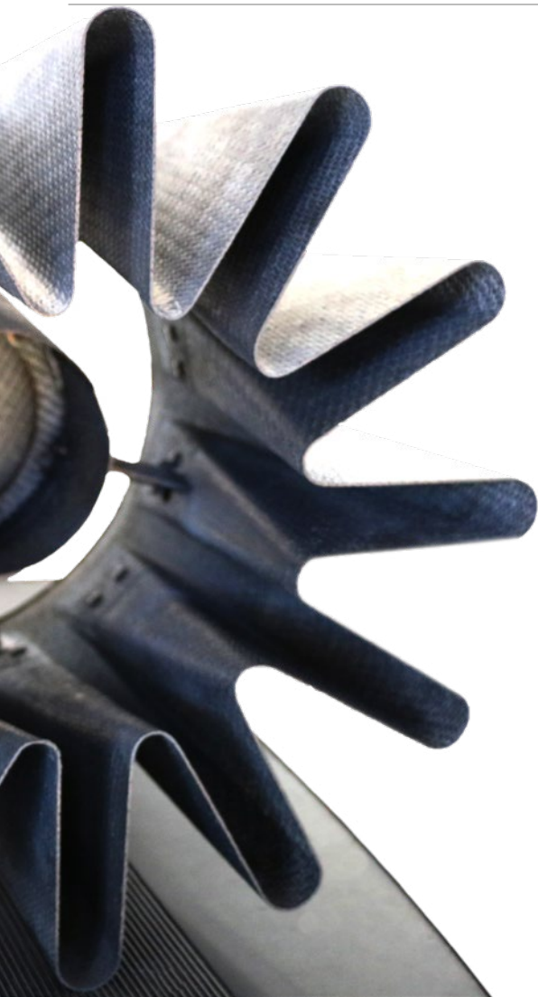
Tuyère de moteur d'hélicoptère en composite céramique.
